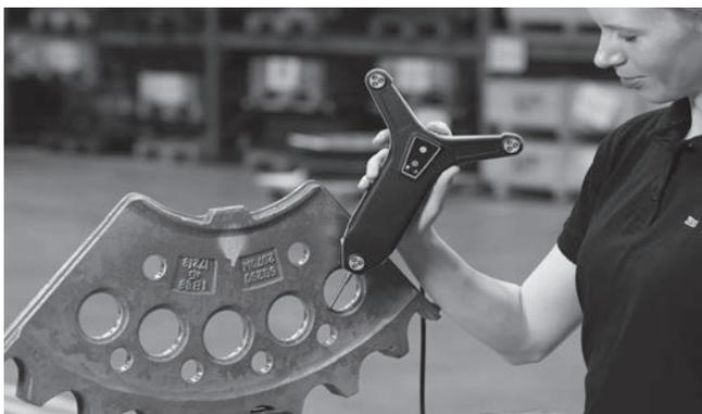
Handgeführte Touchprobe ZEISS T-POINT - die ideale portable Koordinatenmessmaschine für einfache Einzelpunktmessungen
