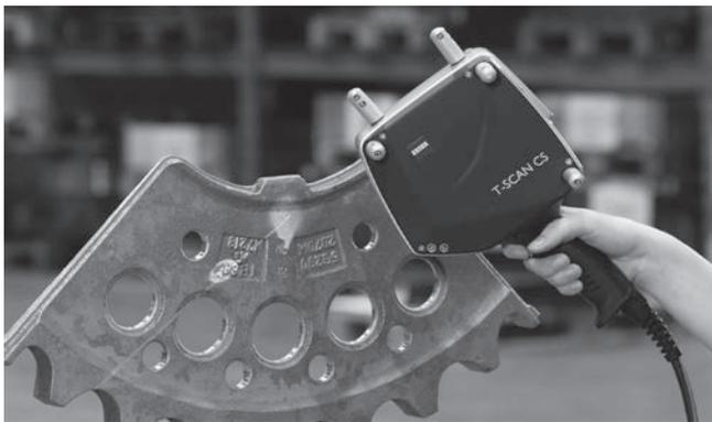
Schnelle und intuitive 3D-Datenerfassung mit dem handgeführten Laserscanner ZEISS T-SCAN
